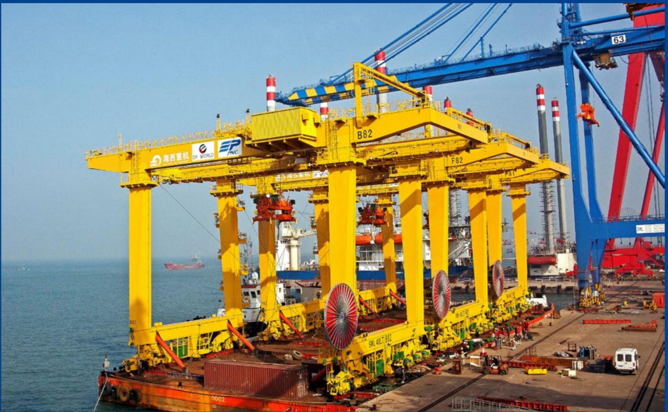
| 机电装备：武汉船机40T龙门吊 |
